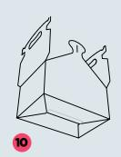
Tomando como referencia la imagen 6, se deben doblar los paneles según se muestra en la secuencia, enganchando las aletas de los paneles 2 y 3 con las del 1. Al final, se debe introducir la aleta del panel 4 en la ranura que queda al unir las anteriores.
